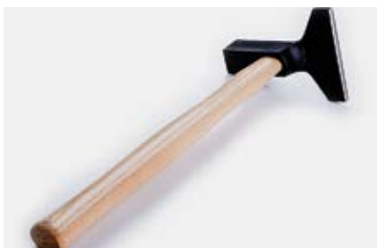
Кромковтирочный молоток, цельнокованный Используется для выдавливания воздушных пузырей и лучшего приклеивания покрытия. Особенно полезен рядом со стенами и на стыках.
